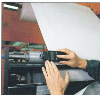
Mekanisk varvtalsmätning på en vals
