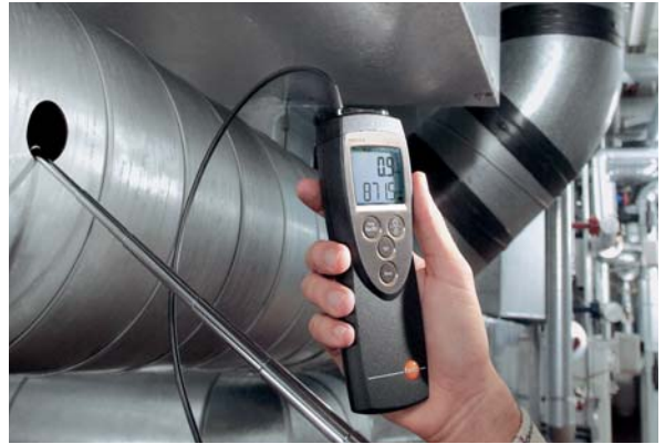
testo 425, t.ex. för mätning av volymflöde i ventilationskanaler
