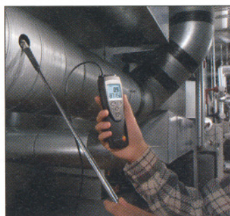
Mätning av volymflöde i frånluft.
