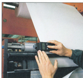
Mekanisk varvtalsmätning på en vals
