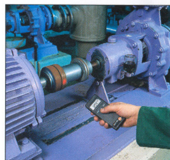
Varvtalsmätning på axlar
