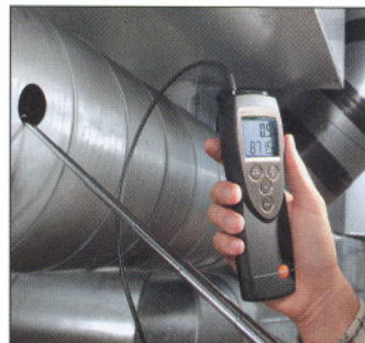
Mätning av volymflöde i ventilationskanaler.
