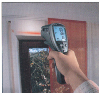
Mätning av temperatur på väggytor
